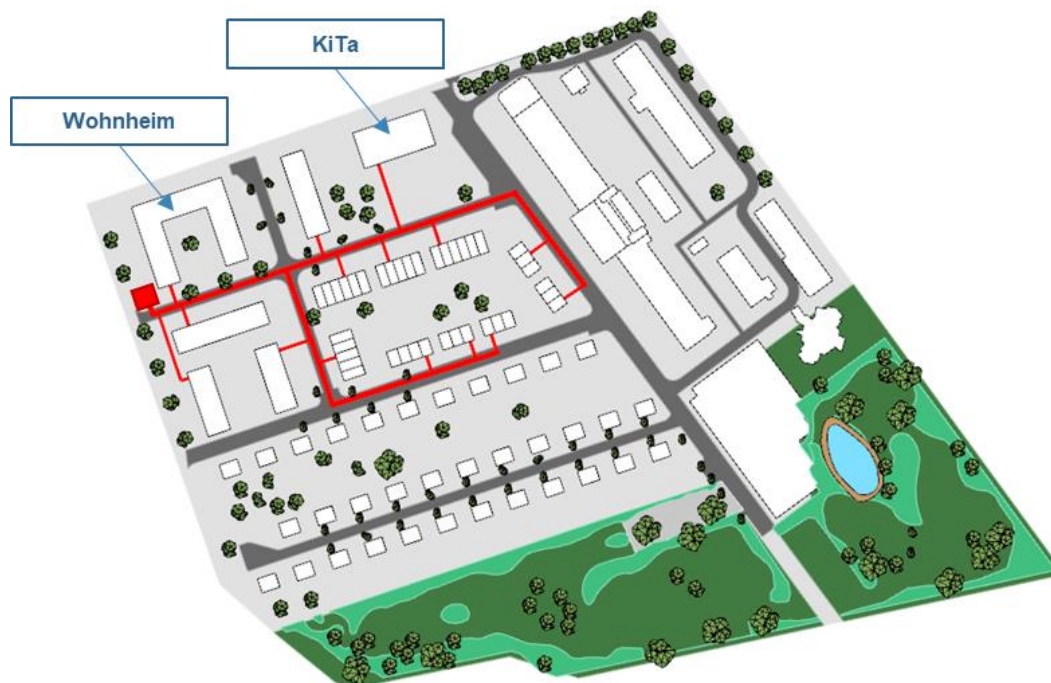
Abbildung 16 Lageplan Teilgebiet 2 mit Trassierung Nahwärmenetz
