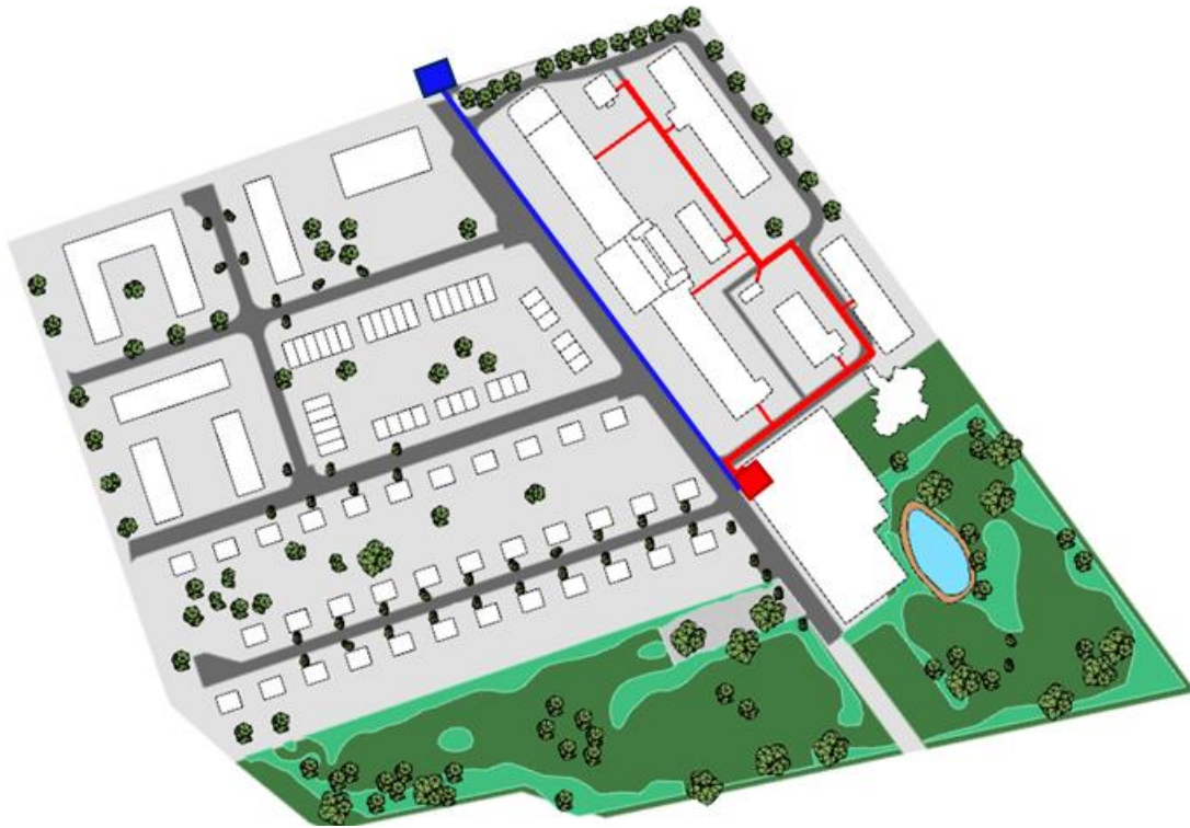
Abbildung 17 Lageplan Teilgebiet 3 mit Trassierung Erdgasanschluss sowie Nahwärmenetz
